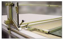
Pinza móvil final de capa para extendido simple o encarado (zigzag)
