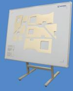
Coloque las plantillas existentes en la superficie del digitalizador y capture el perímetro y la geometría interna.
