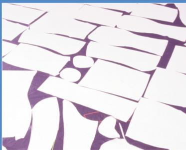
El sistema Taurus corta con una tolerancia cero entre las piezas para reducir las pérdidas de material cuando se utilizan tintes.
